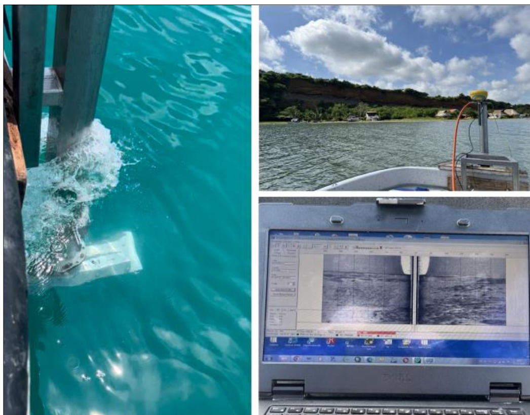
Figura 5-4. Adquisición de información de Sonar de Barrido Lateral en el sector de Puerto Velero (Izq.). Sistema global de navegación GNSS (Global Navigation Satellite System) con antena externa (Der. sup). Imagen en tiempo real del fondo marino en escala de grises (Der. inf). (Fuente: Programa de Geociencias marinas y costeras)
